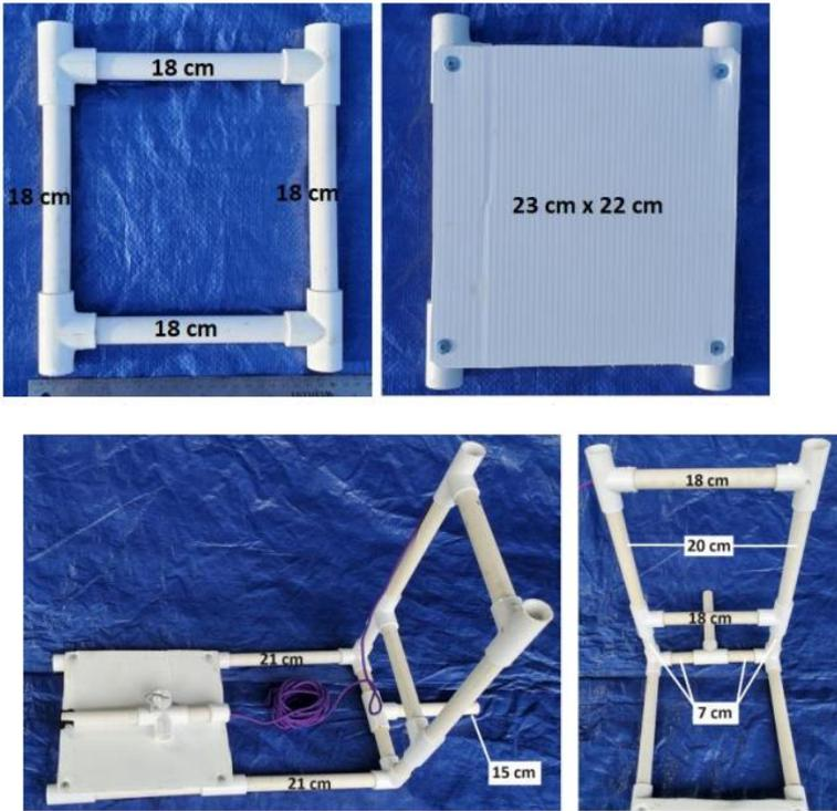
坞站是一个方形的 PPR 20mm 管，长 18cm，有四个三通。由片状材料(如波纹塑料、铝塑板等)制成的矩形固定在顶部。平台是配重的。
